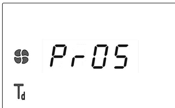
fig. 15 – Ejemplo de visualización en pantalla . Programa 5 seleccionado. El programa incluye una fase de secado : el LED de secado está encendido. El programa incluye una fase de termodesinfección : el LED «Td» está encendido.
