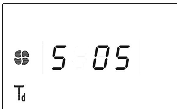
fig. 21 – Visualización en pantalla de la pausa del programa 5: «S 05».
