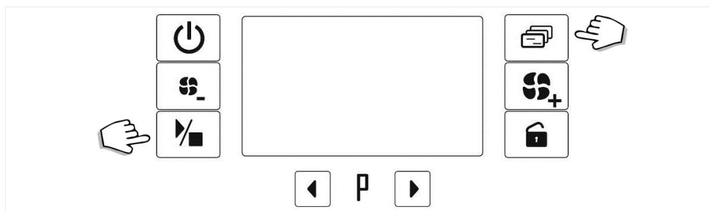
fig. 27 – Botones de selección del ciclo de RESTABLECIMIENTO : pulsación simultánea y prolongada de los botones Arranque/parada + Funciones .
