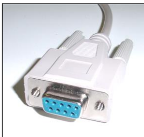
fig. 64 – Conector hembra RS-232.
